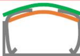
墙膜：Silostop 氧气阻隔墙 膜 顶膜：阻氧膜 + 黑白 膜
