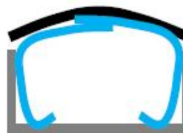
墙膜：传统透明膜 顶膜：透明膜+黑白膜
