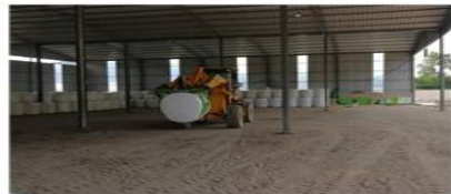
收获后进行打捆包膜，再用夹包搬运机搬运到指定位置贮存
