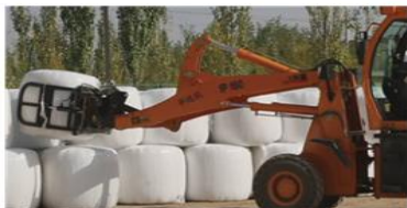
打捆包膜后用夹包搬运机搬运到指定位置贮存
